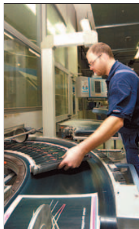
Ausgabe der beidseitig bedruckten rotationsgefalteten Produkte Produits pliés et imprimés recto-verso sortant de la rotative
