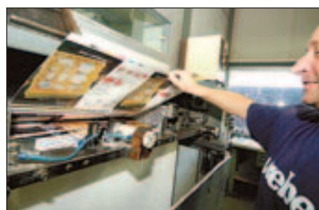
Planoauslage: Die Papierrollen werden nach der beidseitigen Bedruckung zugeschnitten. Sortie plano: les rouleaux de papier sont découpés après l'impression recto-verso.
